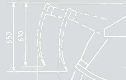
TELESKOP-RAHMEN MIT VERSCHIEDENEN SPANNWEITEN UND RAHMENBREITEN AM TYP HN-TS. DER ANBAURAHMEN WIRD MITTELS SCHNELLSTECK-EINRICHTUNG BEFESTIGT.
