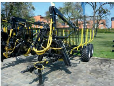
Dreipunktkran mit Teleskopstützfüssen
