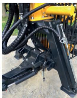
Dreipunktkran mit Teleskopstützfüssen
