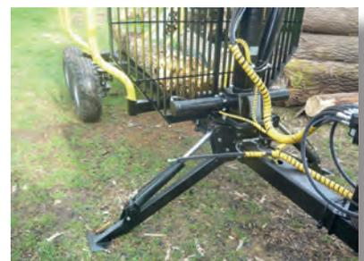
Flanschkran mit Klappstützfüssen
