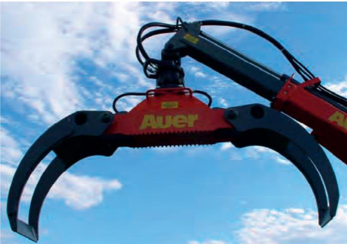
Rückegreifer mit Rotatorplatte
